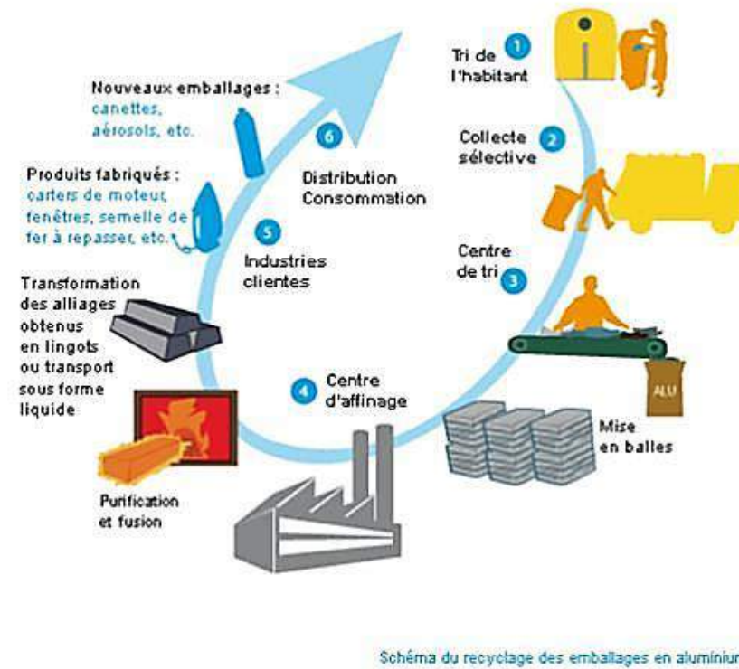
Figure 9 : Schéma du recyclage des emballages en aluminium
