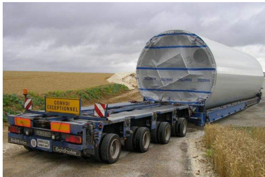
Photo 8 : Transport d'une section de tour d'éolienne sur site
