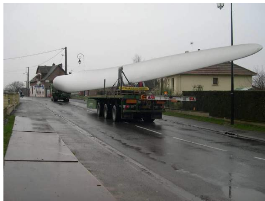
Photo 58 : Camion de transport des pales d'une éolienne
